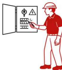
3. Reconocimiento de la ausencia de tensión.
