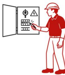
3. Reconocimiento de la ausencia de tensión.
