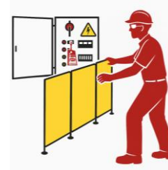
5. Delimitar la zona de trabajo mediante señalización o pantallas aislantes.
