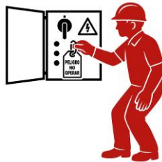
2. Enclavamiento o bloqueo si es posible, de los aparatos de corte.
