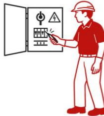
3. Reconocimiento de la ausencia de tensión.
