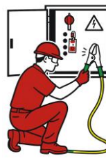
4. Poner a tierra y en cortocircuito todas las posibles fuentes de tensión.
