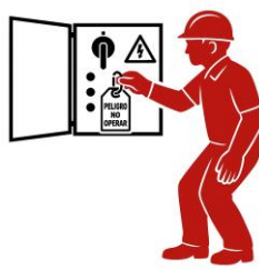
2. Enclavamiento o bloqueo si es posible, de los aparatos de corte.
