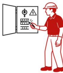
3. Reconocimiento de la ausencia de tensión.
