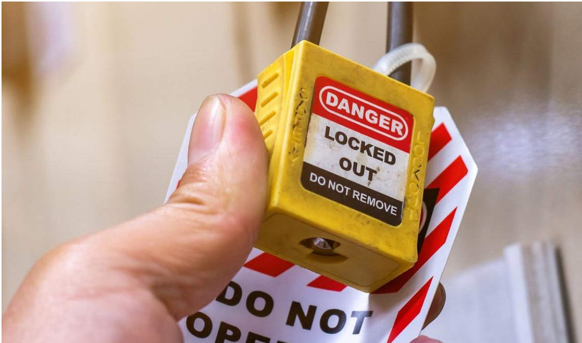
Ilustración 3. Ejemplo de candado de bloqueo Fuente: LUDUS
