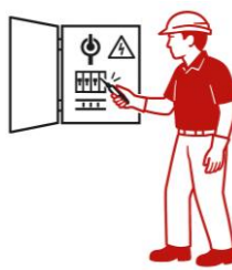
3. Reconocimiento de la ausencia de tensión.
