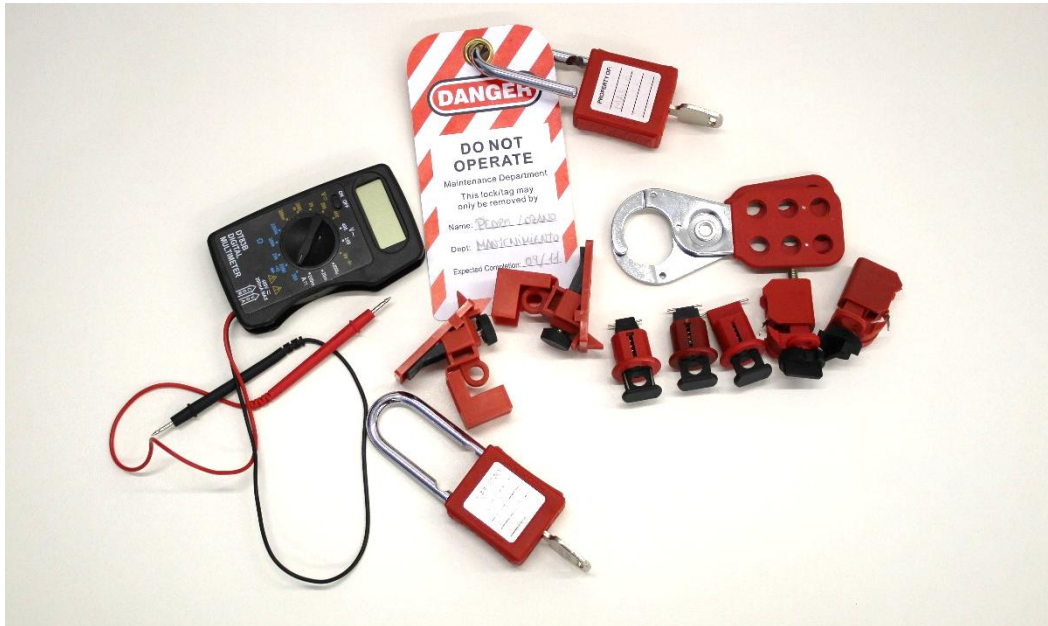
Ilustración 1. Ejemplo de dispositivos de consignación eléctricos. Fuente: CTM.
